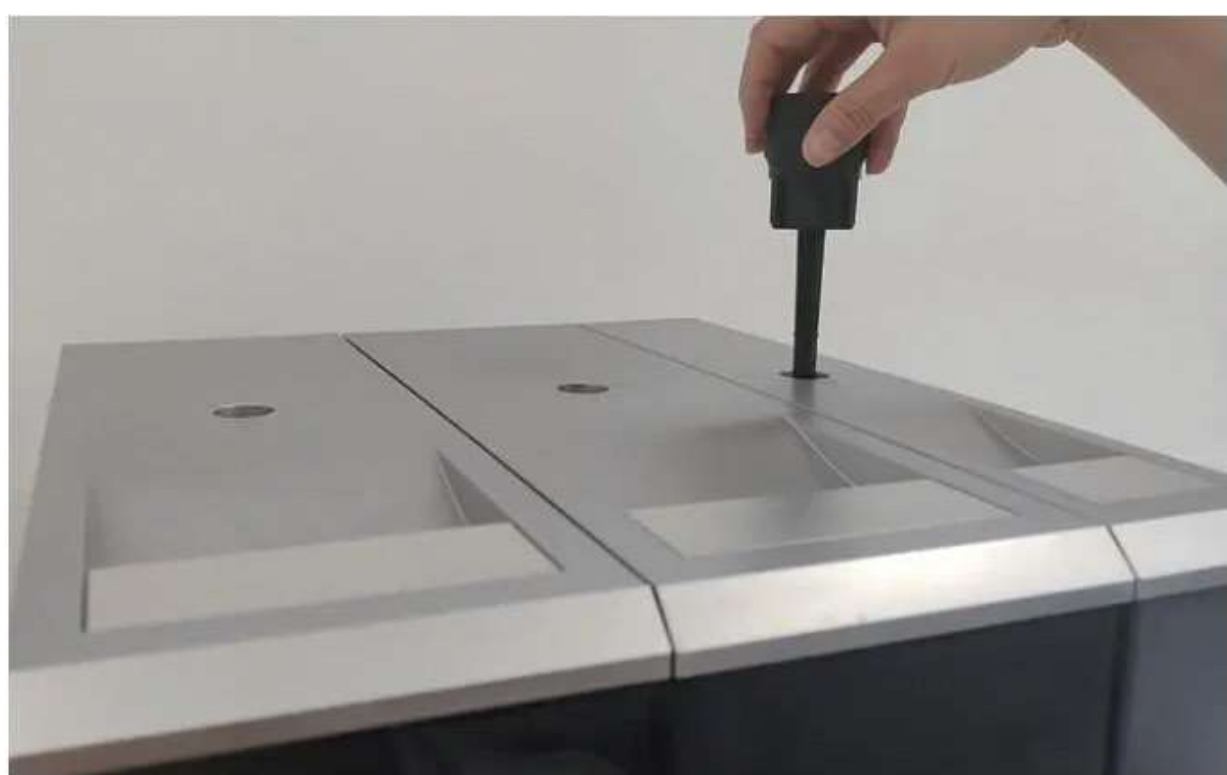
1. Разблокируйте крышку бункера для порошков используя ключ (при необходимости)
