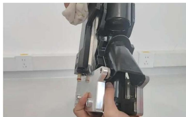
6. Протрите заварочный блок сухой тканью и дайте ему полностью высохнуть перед установкой в кофемашину
