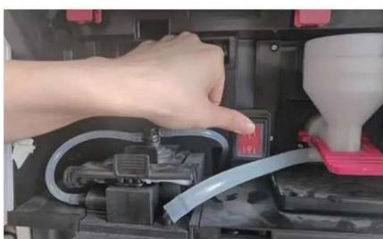
1. Поднимите переднюю операционную (дисплейную) панель и включите питание
