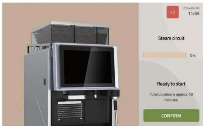
Сообщение на дисплее «Декальцинация линии пара» необходимо провести процесс декальцинации с чистящим средством. Процесс декальцинации линии пара аналогичен декальцинации линии кофе. Следуйте инструкциям на дисплее для корректного проведения процесса декальцинации
