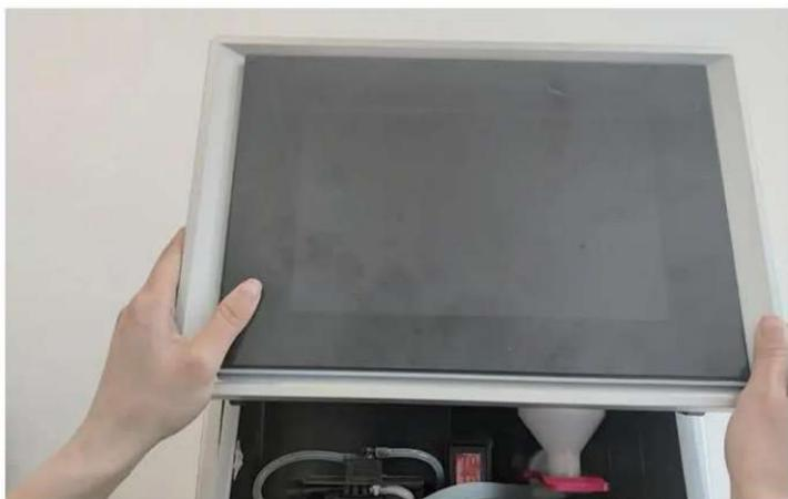
2. Разблокируйте дисплейную панель при помощи ключа и поднимите её
