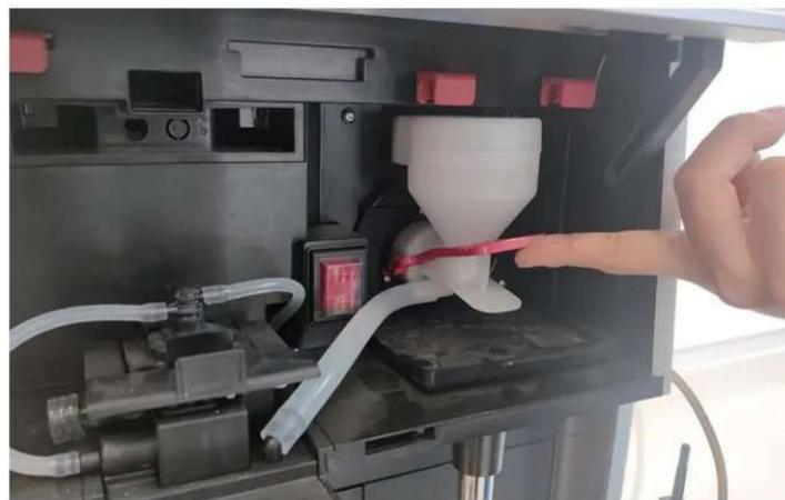
3. Снимите фиксатор миксера для его разблокировки
