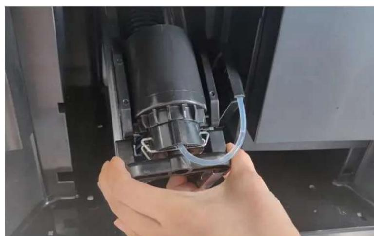
4. Аккуратно потяните заварочный блок вниз, затем наклоните его на себя и извлеките его, как показано на рисунке
