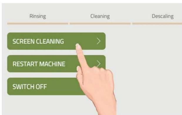
Войдите в «Обслуживание/ Быстрое меню». Выберите пункт «Очистка дисплея» для отключения дисплейных сенсоров на 15 секунд. Протрите экран сухой тканью.
