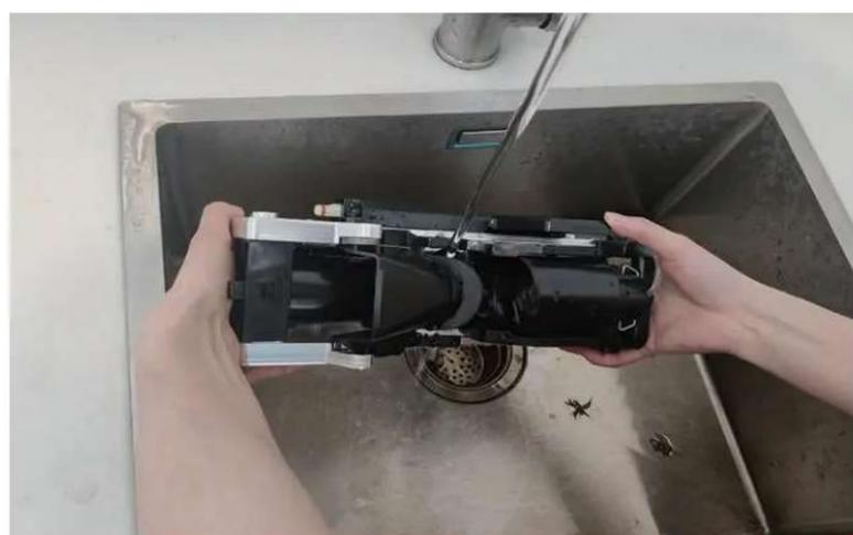
5. Промойте заварочный блок под проточной водой
